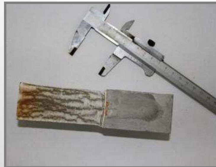
Испытание проводилось в 12 % растворе соляной кислоты. Время выдерживания 2 ч.
